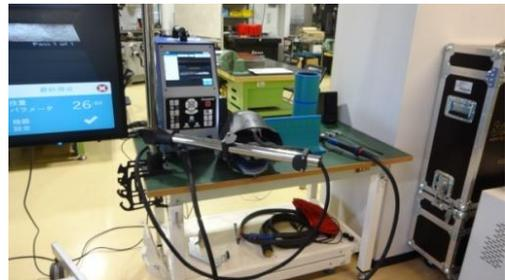
図10 溶接シミュレータ
